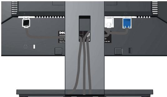
Después de conectar todos los cables necesarios al monitor y al PC, (consulte [Conectar su monitor](#) para conectar los cables), utilice la ranura de sujeción de cables para organizarlos correctamente tal y como se muestra arriba.
